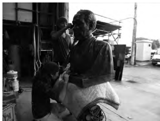
図3 FRP像製作 カシュー塗料による色調調整
