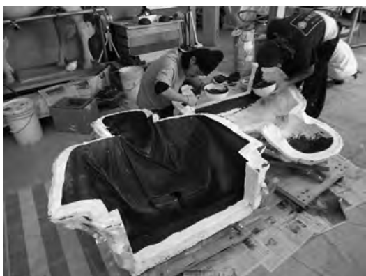
図1 FRP像製作 シリコン型に樹脂を塗り込む
